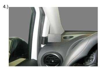
Bitte vor der Montage die Anleitung aufmerksam lesen und die Bilder ansehen. 1 und 2. Die Gummidichtung an der A-Säule ein wenig ziehen. Die angewinkelte Kante am unteren Ende des ProClip in den Spalt drücken und um die A-Säule festhaken.
